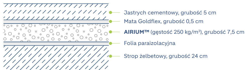
Rys. 1. Przekrój przez badane stropy
