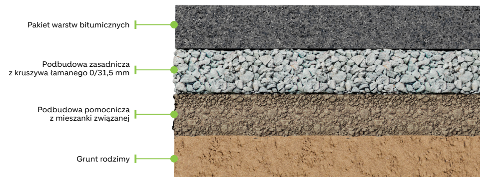
Rysunek 3. Przekrój konstrukcji drogowej nawierzchni podatnej/półsztywnej
