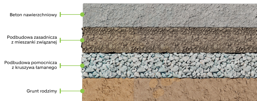
Rysunek 4. Przekrój konstrukcji drogowej nawierzchni sztywnej
