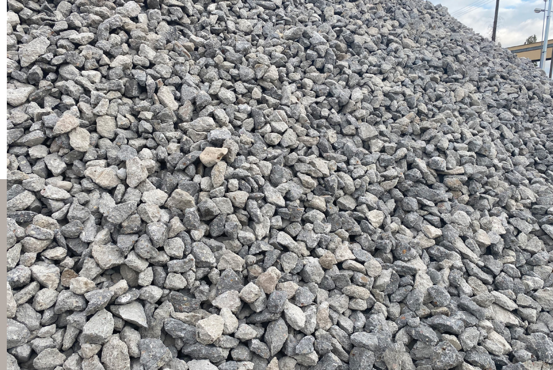
Wygląd kruszywa z recyklingu z czystego betonu
