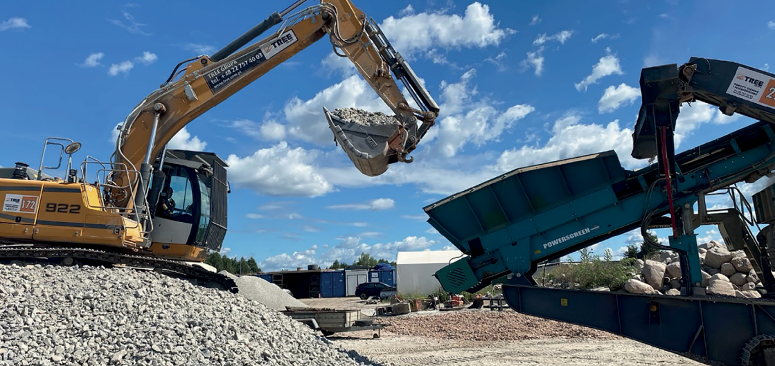
Przesiewanie kruszyw na odpowiednie frakcje
