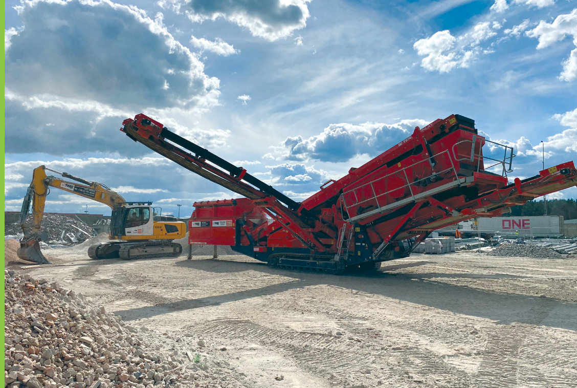
Przesiewacz do frakcjonowania kruszyw podczas produkcji
