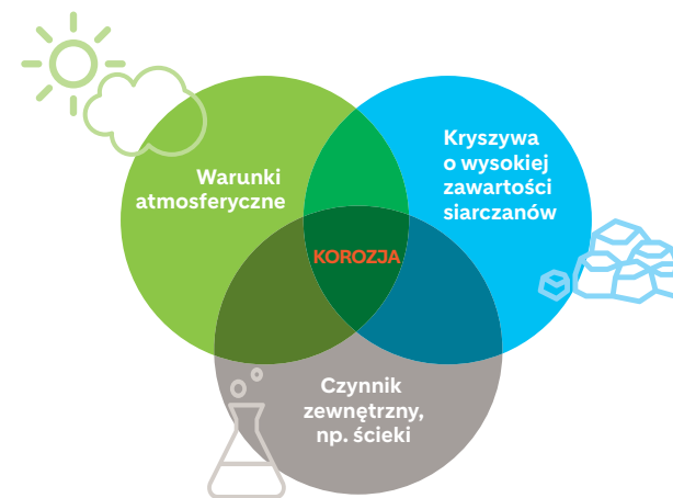
Rysunek 10. Czynniki wywołujące zjawisko korozji. Niekorzystne warunki atmosferyczne – środowisko bardzo wilgotne
